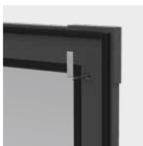
Ressort d'accrochage sans perçage, convient pour des épaisseurs de cadre de 8 à 30 mm
